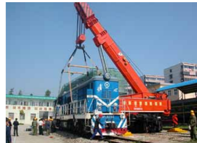
采用迪尼玛®纤维制造的起重索具在铁路紧急救援作业中更加安全、高效和有效。
